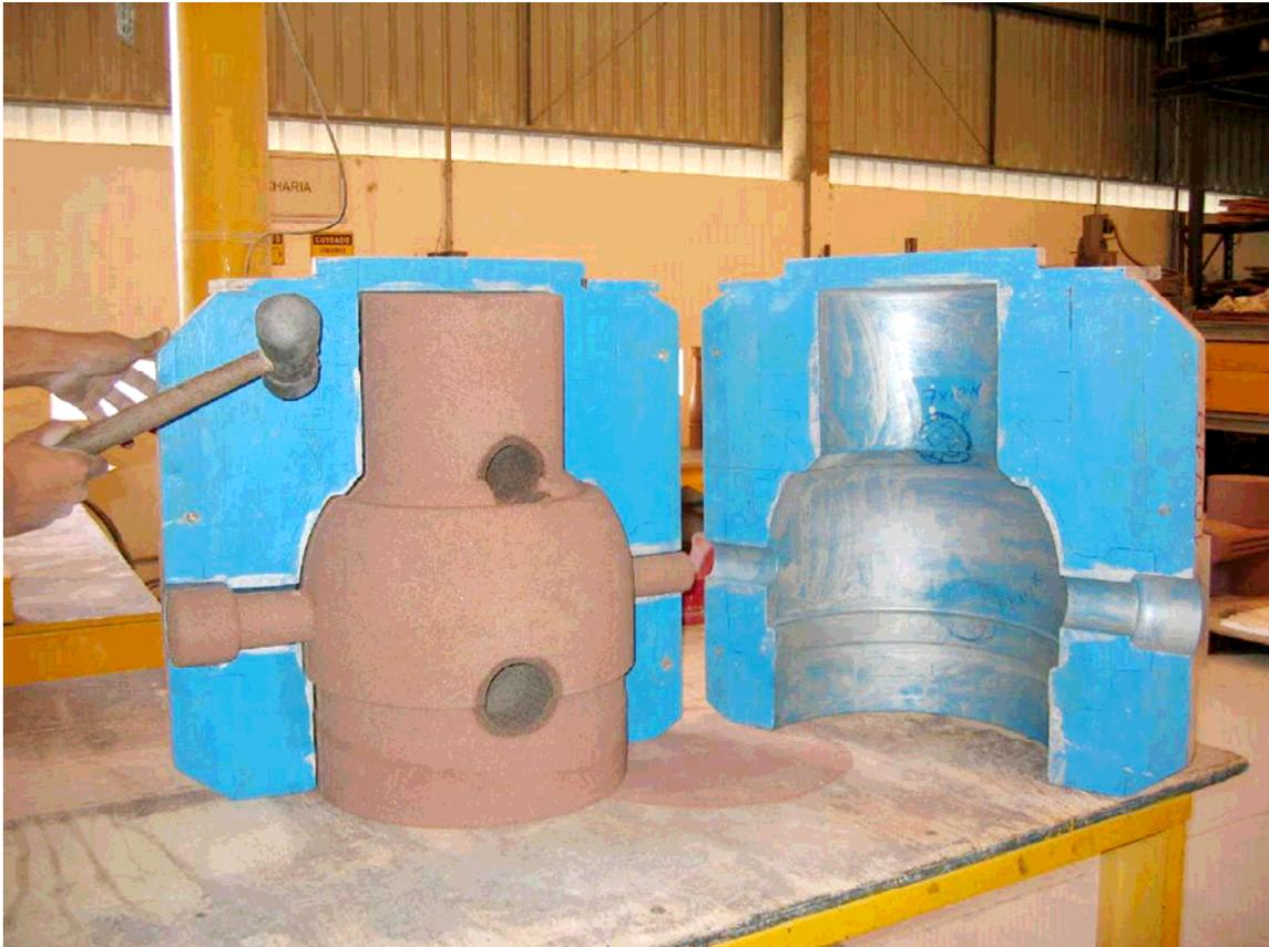
Macho sendo retirado da caixa após cura da areia.
