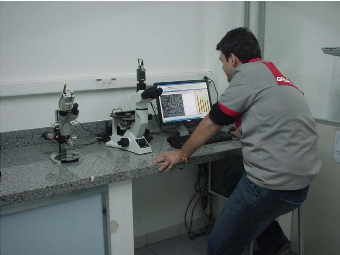
Equipamento para a determinação da micro estrutura do material
