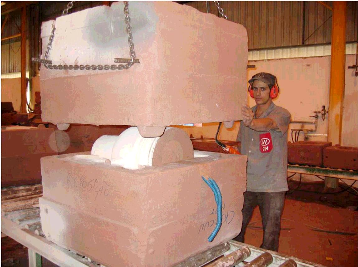
O molde composto de duas partes para permitir o assentamento do macho em seu interior. Observar os cordões azuis que são os respiros para a saída dos gases de combustão da resina do macho.
