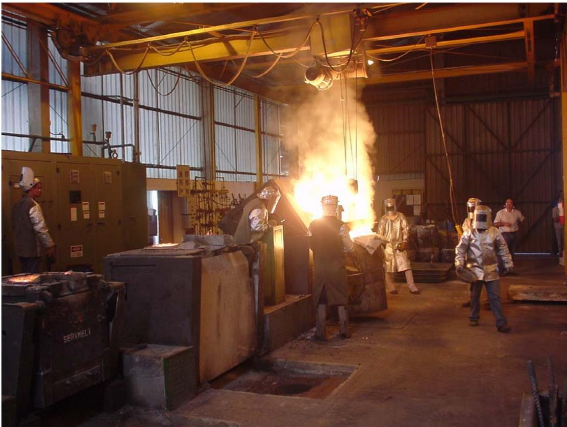
Transferência do metal líquido do forno para a panela de vazamento
