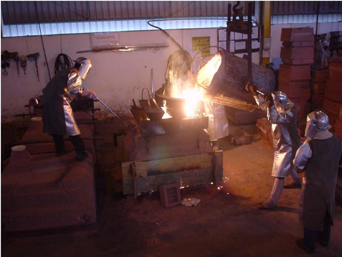
Instante do vazamento do metal da panela para o molde
