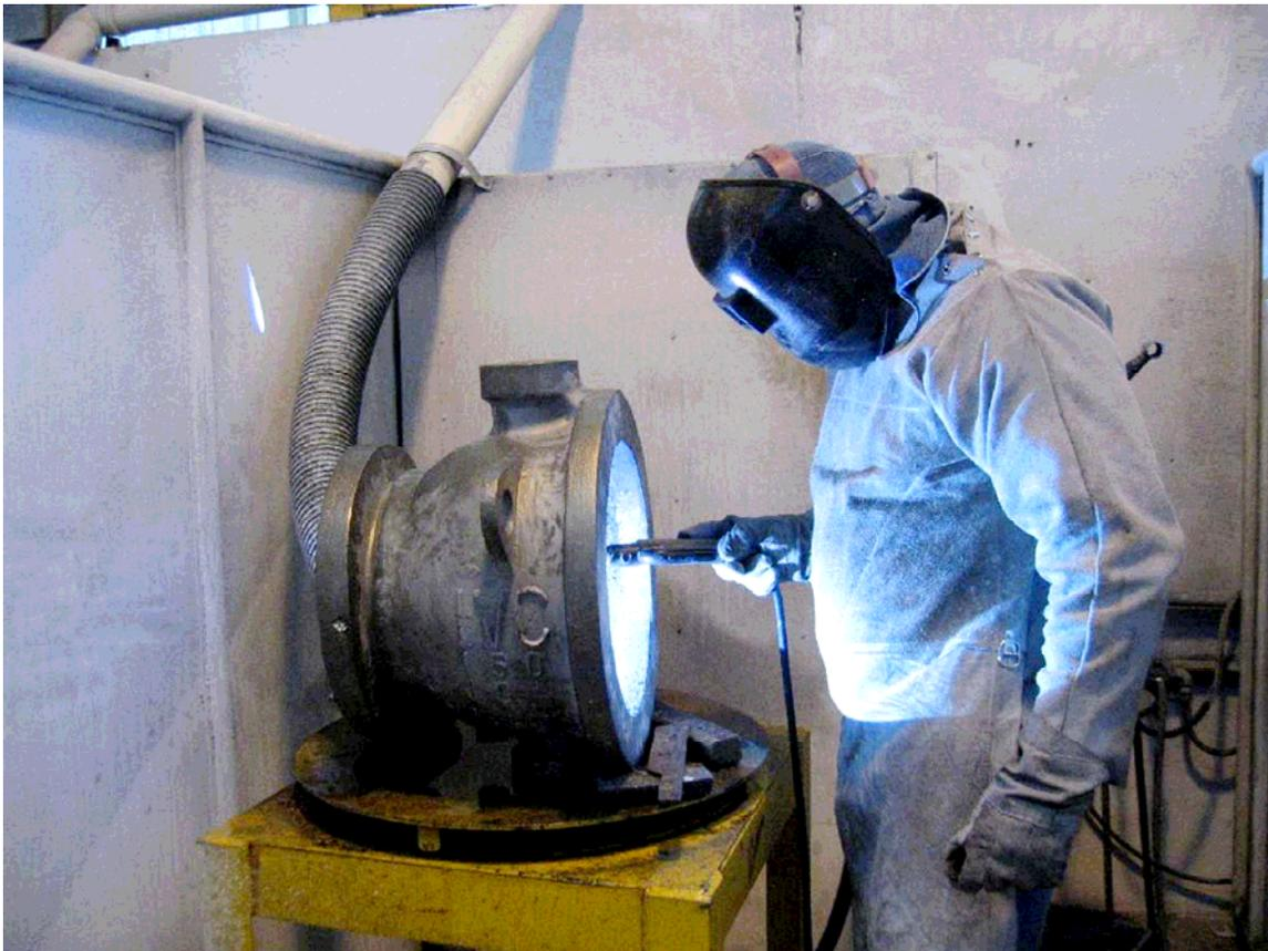
Reparo por solda com eletrodo revestido
