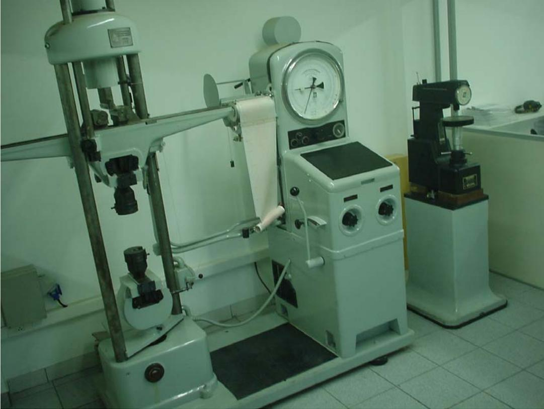
Equipamento para ensaios físicos do material: tração e dureza
