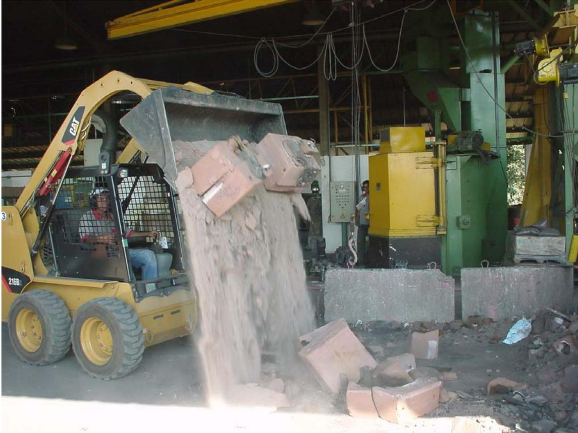
Quebra do molde de areia para a retirada da peça na desmoldagem.
