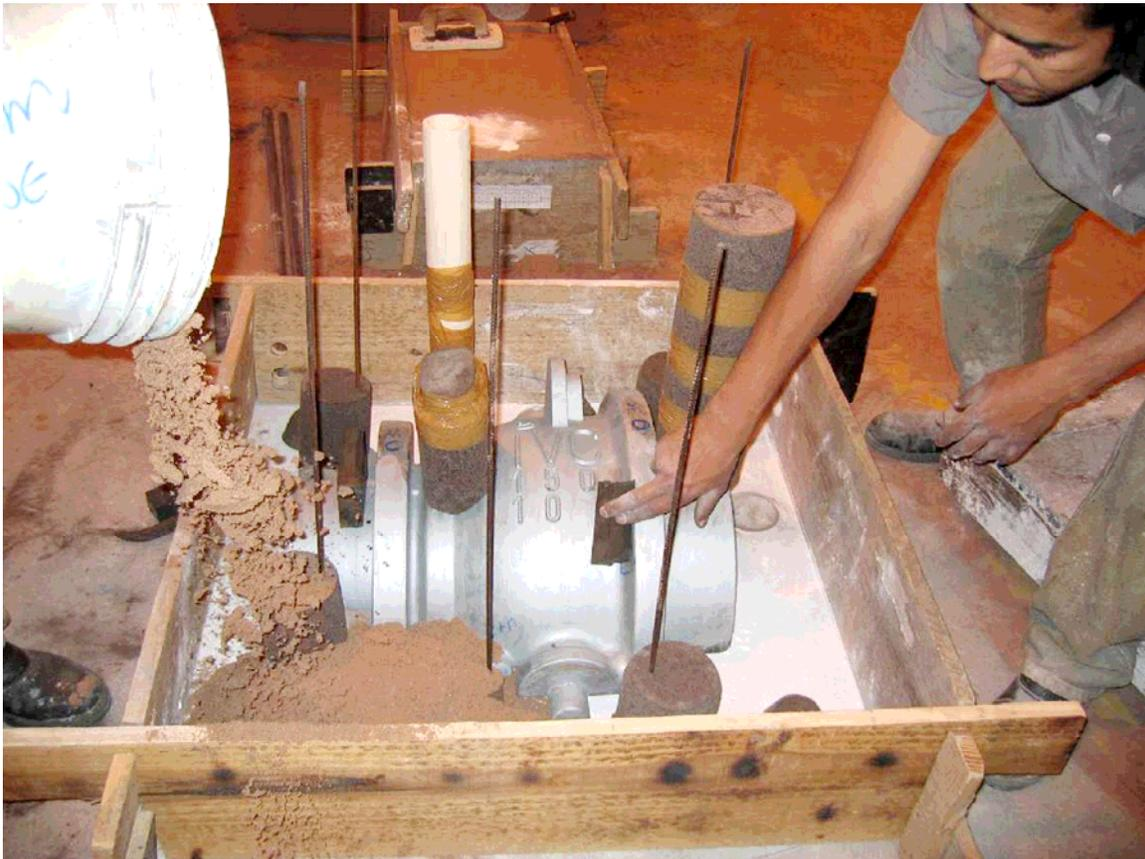
Moldagem: detalhe da colocação dos resfriadores, massalotes, respiros e canais de vazamento
