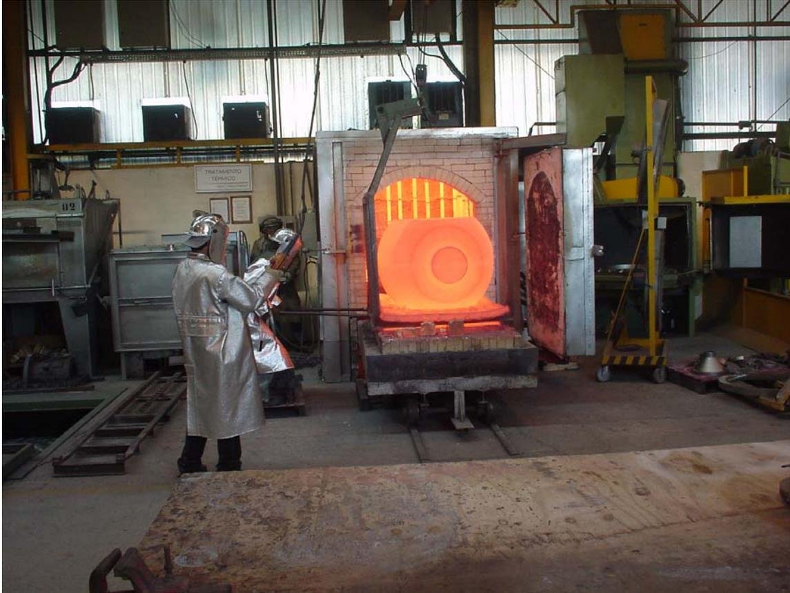
tratamento térmico de solubilização: a carga é retirada do forno de tratamento térmico e imediatamente colocada no tanque de água.
