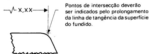
Pontos de intersecção deverão ser indicados pelo prolongamento da linha de tangência da superfície do fundido.
